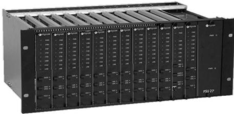
Le connessioni analogiche sono gestite utilizzando l'apposita scheda, conforme alla normativa V34+; questa scheda è flash downloadable e quindi predisposta per supportare tutta una serie di nuove funzioni. E' l'ideale per tutte le applicazioni sincrone e asincrone, lato client o server; possiede delle funzioni particolari che consentono di risolvere problemi applicativi con altri modem difficilmente risolvibili.
